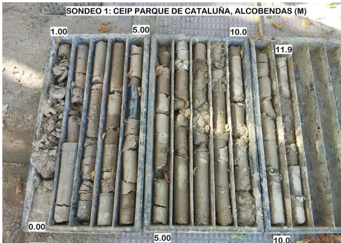
FOTOGRAFIA 2: Vista de los testigos del sondeo 1.
