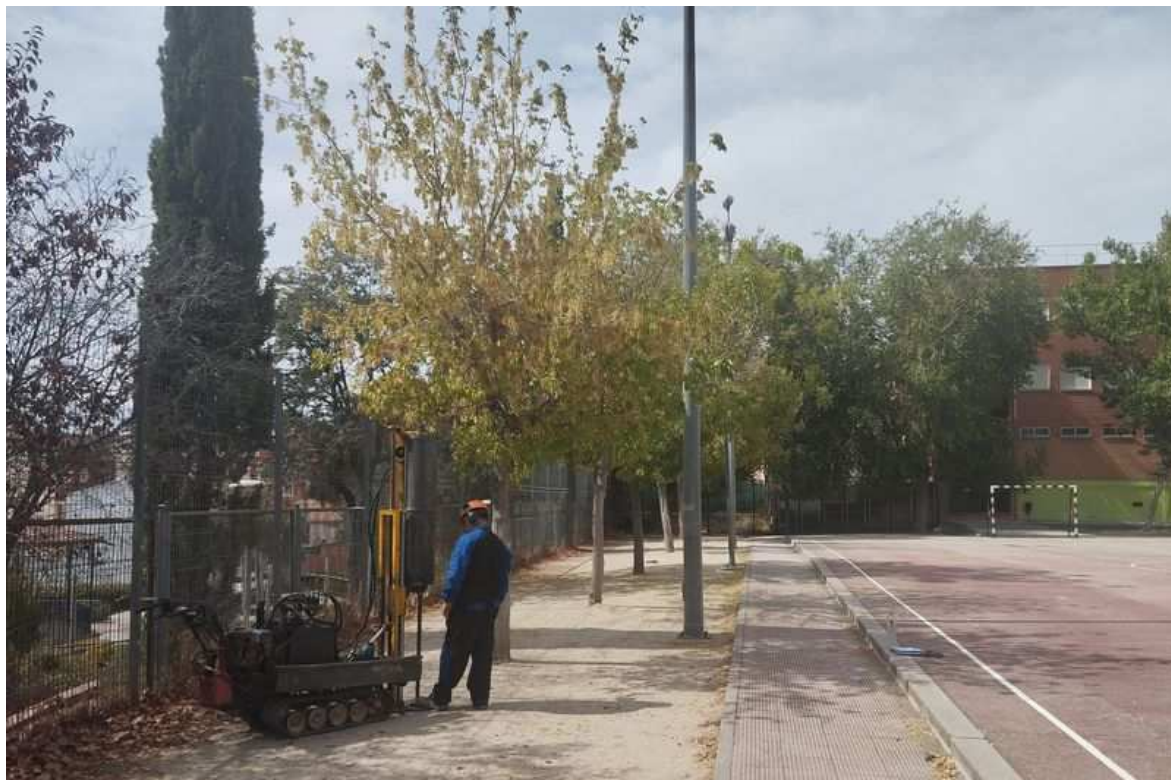
FOTOGRAFIA 6: Vista de la realización del penetrómetro 2.
