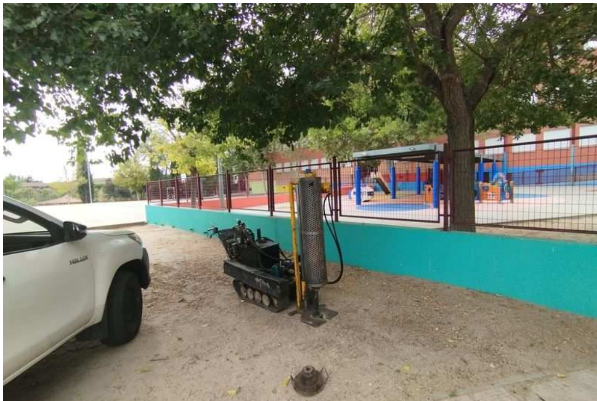
FOTOGRAFIA 7: Vista de la realización del Penetrómetro 3.
